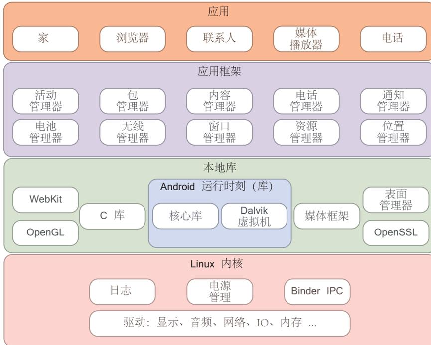
图 21.1: Android 操作系统构架
