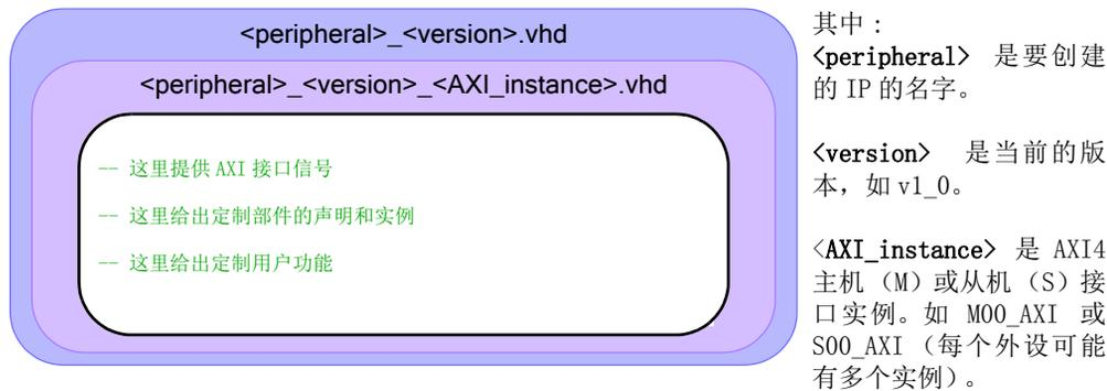
图 13.2: HDL 外设源文件架构
